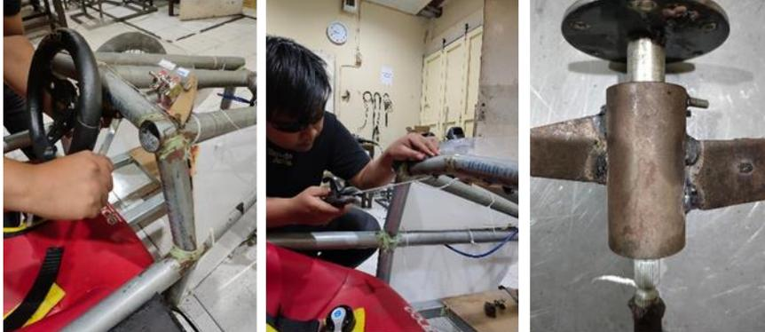
Gambar 3 Pembuatan bracket poros steering dan pemasangan poros steering
