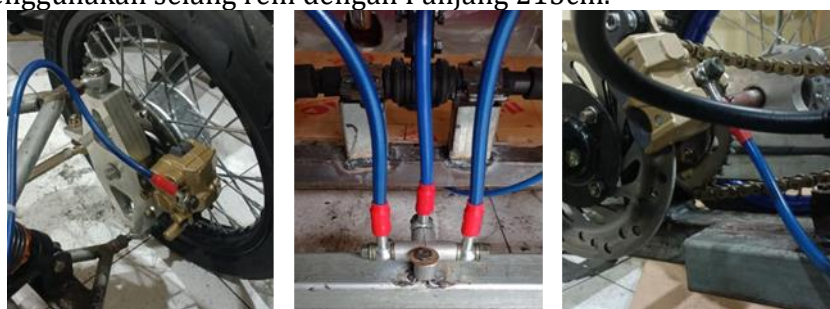
Gambar 6 pemasang dan penataan selang rem
