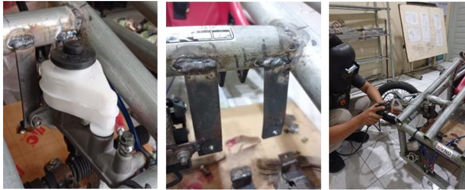
Gambar 4 Pembuatan bracket dan pemasangan master rem
