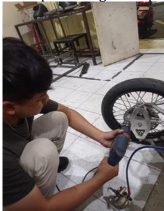
Gambar 2 Penyesuaian dudukan caliper
